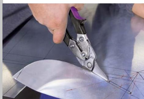
\* Ножницы можно кратковременно использовать для резки фальцев толщиной до 3 x 0,6 мм (1,8 мм).
