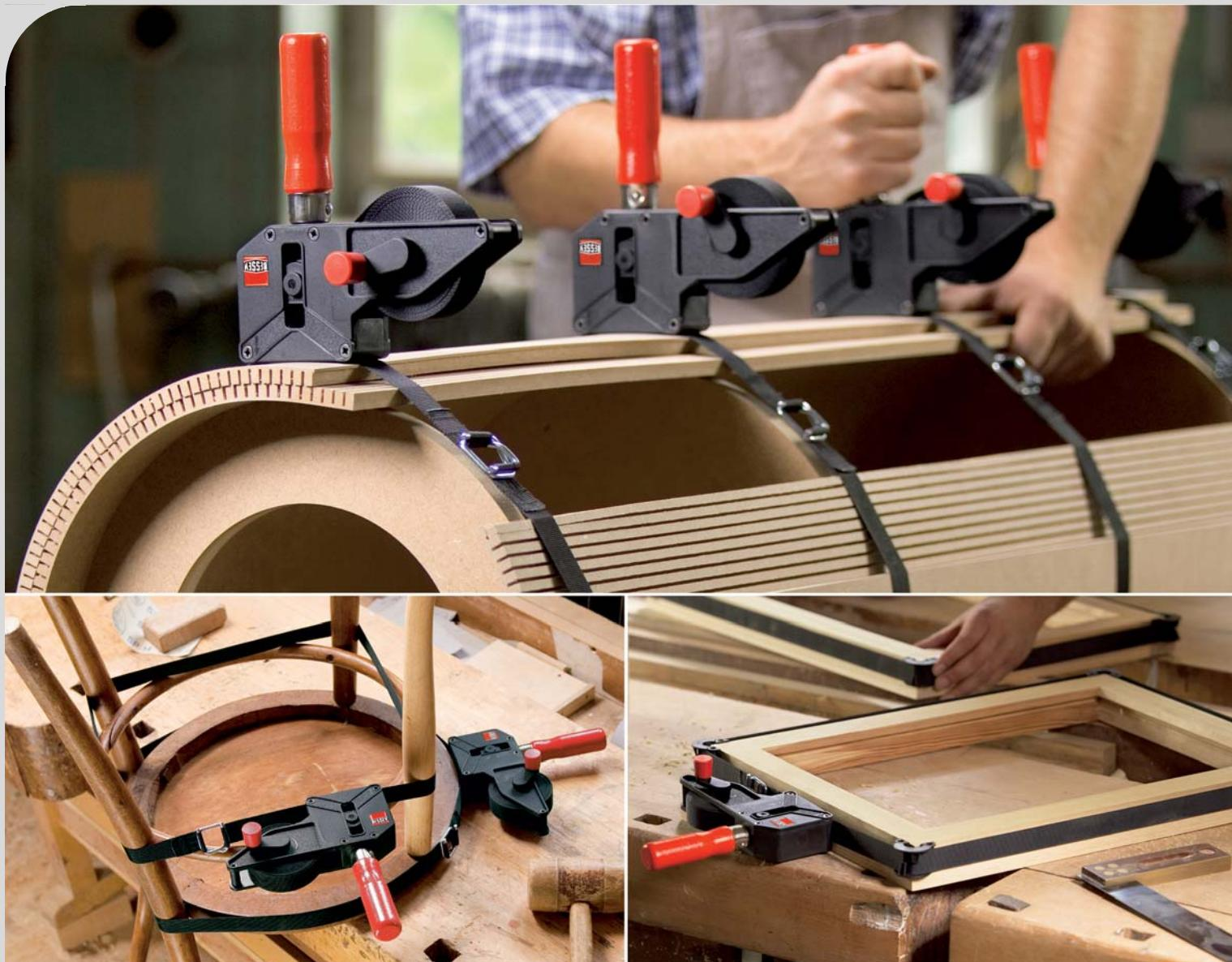
Двусторонний равномерный зажим без перекоса
